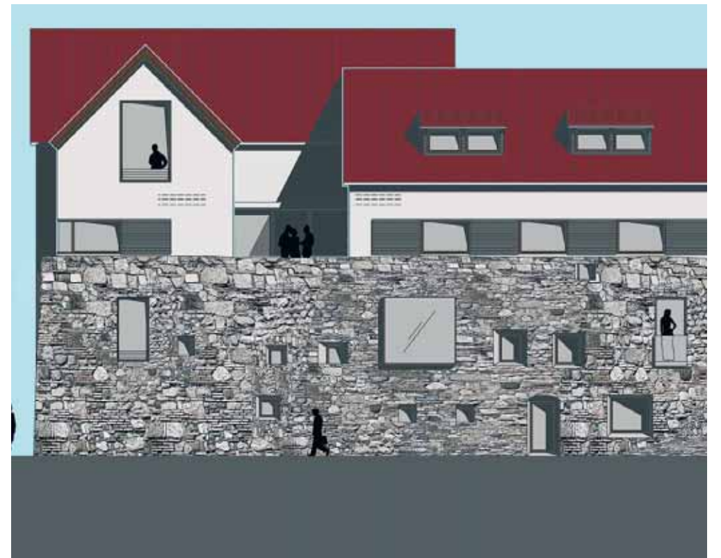
Schicke Kombination aus Alt und Neu: An der Südseite soll die alte Stadtmauer in das neue Gebäude mit seinen dreieinhalb Stockwerken integriert werden. FOTO: SMAGER
